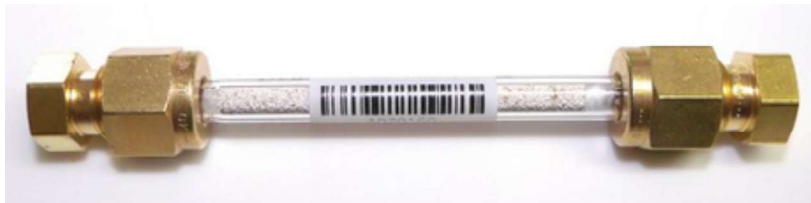
Figure 2 : Dispositif expérimental de prélèvement et d'analyse d'atmosphère
